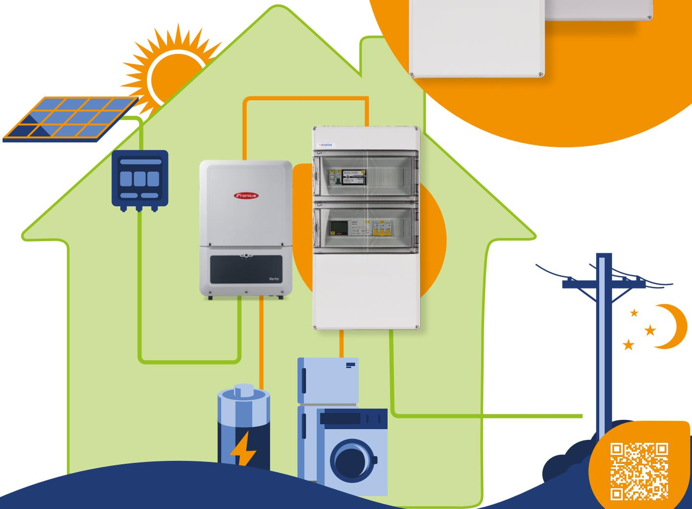
Sie ist in zwei Varianten erhältlich: eine mit FRT-Unterstützung (Fault Ride Through) für den EU-Markt und eine ohne FRT-Unterstützung für den deutschen und Schweizer Markt. Beide Varianten sind bis zu einer maximalen netzseitigen Vorsicherung von 63A betreibbar und bieten eine Vorparametrierung für dreipolige oder allpolige Trennung.
